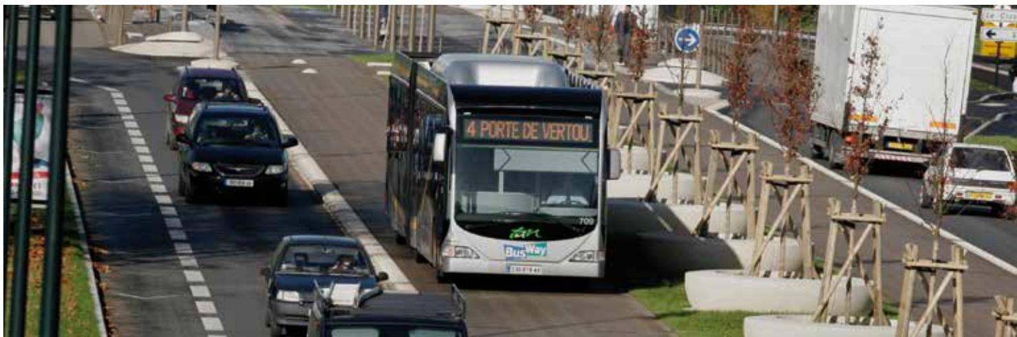
diées ou aménagées, de priorités « intelligentes » aux feux et d'un guidage possible des véhicules (optique ou mécanique), le système BHNS est modulable et à coûts optimisés.
